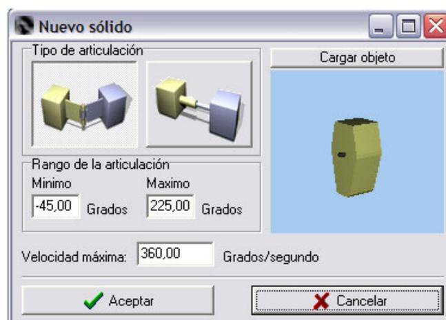
En Esta ventana podremos controlar los parámetros básicos de la articulación. Podremos elegir el tipo, Rotacional o prismática, el rango de la articulación (en grados si es rotacional y en milímetros si es prismática), la velocidad máxima (en grados/segundo si es rotacional y en milímetros/segundo si es prismática) y la geometría pulsando el botón Cargar Objeto. Al pulsar dicho botón abriremos un cuadro de diálogo
