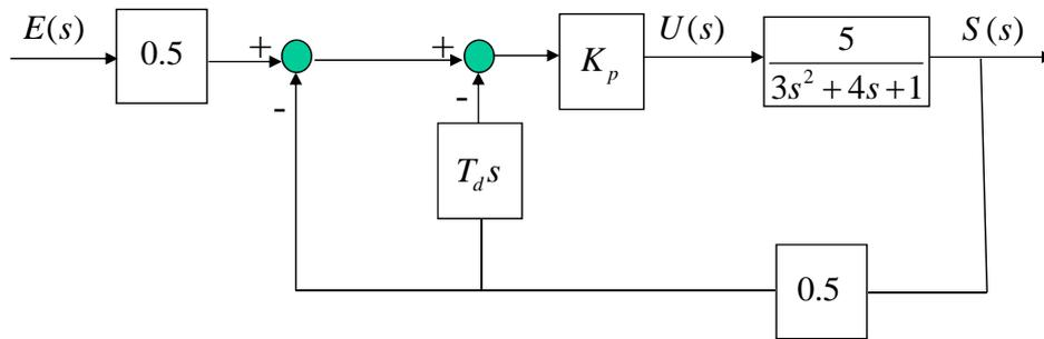
Reestructuremos el diagrama de bloques para calcular  $S(s)/E(s)$ :
