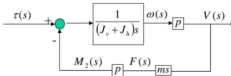
Trasladando el punto de derivación de  $V(s)$  a  $\omega(s)$  y simplificando queda el siguiente diagrama de bloques:
