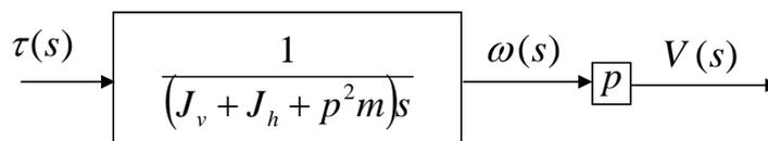
La función de transferencia pedida se obtiene finalmente mediante la multiplicación de los dos bloques en serie:
