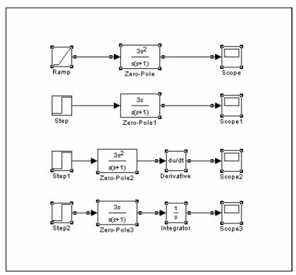
Se pretende simular mediante Simulink, el comportamiento de un sistema de función de transferencia  $G(s) = \frac{3}{s(s+1)}$
