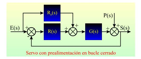
La figura representa el control de un sistema cuyo modelo viene dado por  $G(s) = \frac{3}{s(1+2s)}$ . Se pide:
