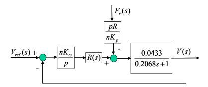
Para eliminar la influencia de la fuerza de rozamiento  $F_r$  en régimen permanente, dado que ésta es de tipo escalón, precisaremos tener un integrador en el regulador R(s). El integrador en el regulador nos proporciona un sistema de tipo 1 en la cadena directa, lo que se traduce en un error de posición nulo, satisfaciendo de esta manera la especificación c. Empezaremos probando con un PI:
