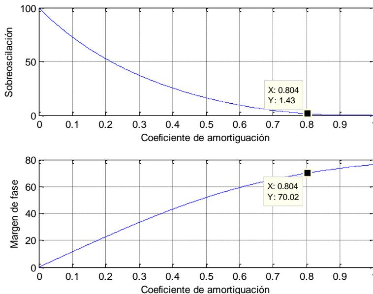
Con el coeficiente de amortiguación y la frecuencia de corte, obtenemos el tiempo de respuesta:
