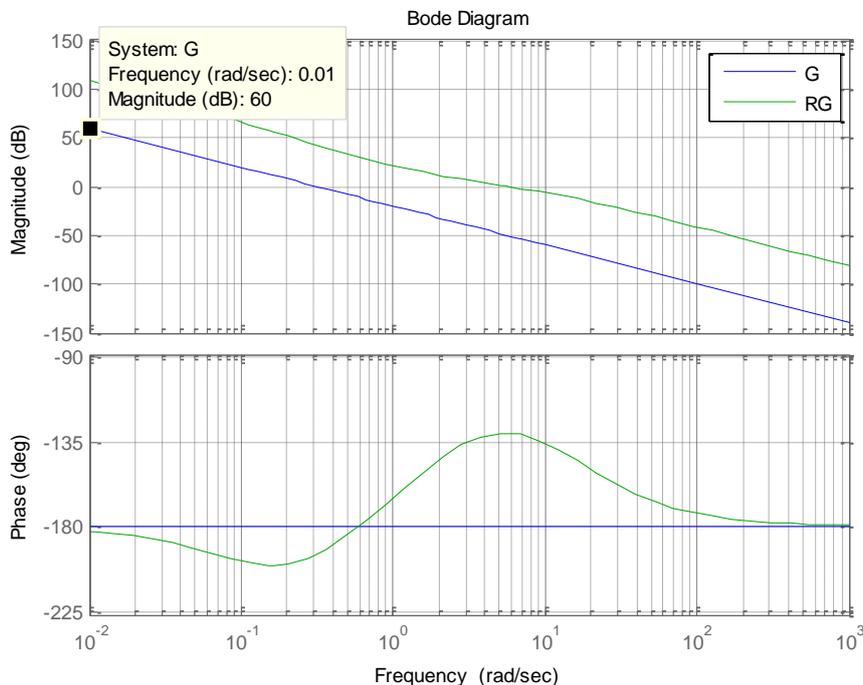
**c)** El comportamiento del sistema controlado lo determinaremos midiendo los parámetros frecuenciales sobre el diagrama del sistema controlado, margen de fase, frecuencia de corte y ganancia estática:
