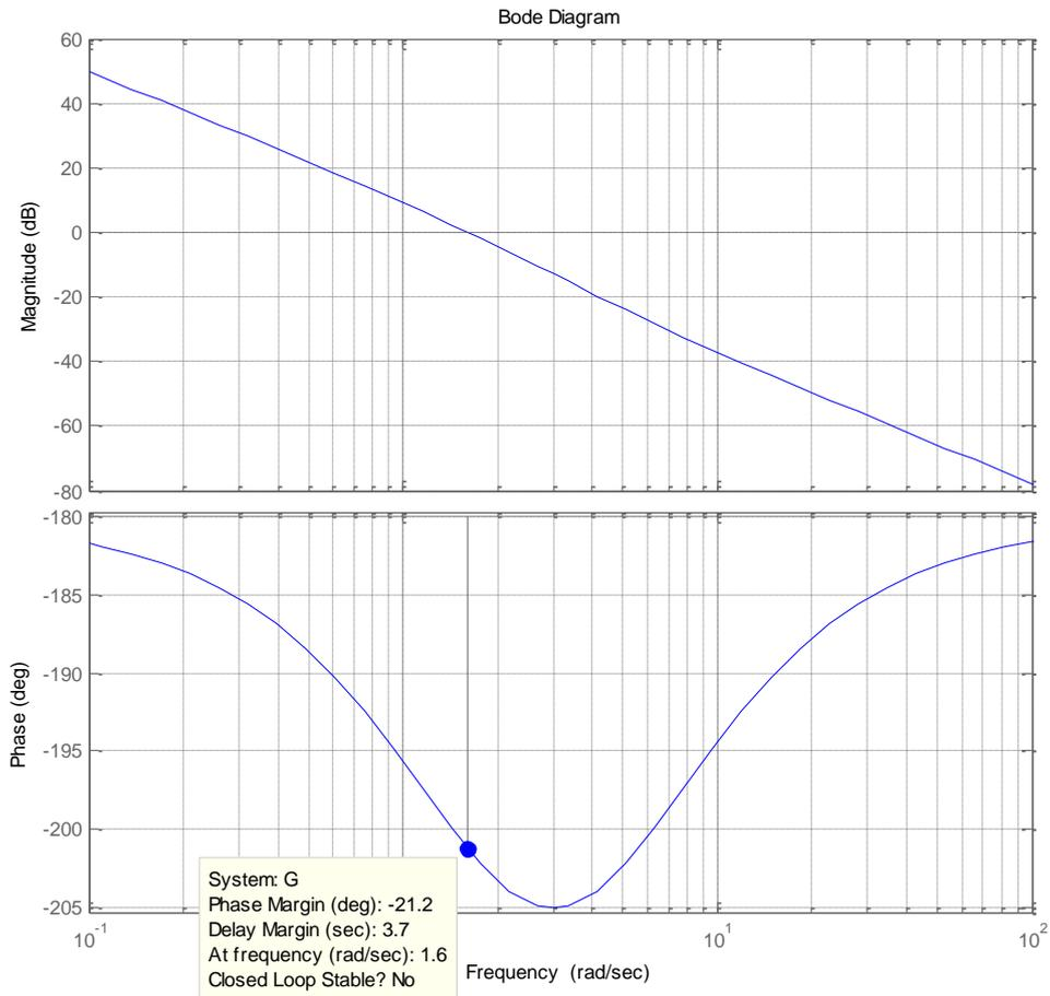
El margen de fase se define como el ángulo que debemos girar la traza de Nyquist en torno al origen para que el sistema se vuelva inestable al interceptar ésta al punto crítico. En el diagrama de bode se representa como la distancia en grados entre la fase y la línea de  $-180^\circ$  a la frecuencia en la que el módulo vale 0 dB (frecuencia de corte).
