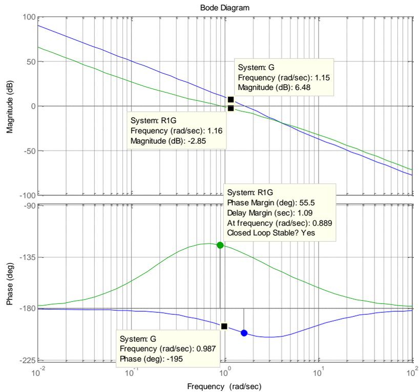
A partir del margen de fase y la frecuencia de corte, determinamos los parámetros de la respuesta transitoria:
