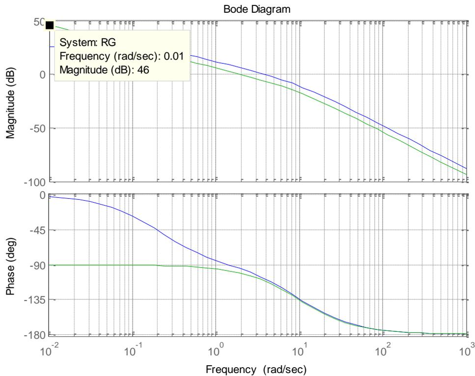
**d)** La respuesta del sistema a controlar cerrando el bucle de realimentación vendrá caracterizada por el margen de fase y frecuencia de corte para la respuesta transitoria, y por la ganancia estática para la respuesta en régimen permanente.
