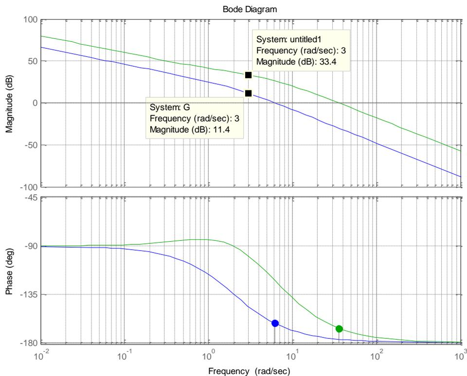
Puesto que la ganancia del regulador está limitada por la condición de error de velocidad, el exceso de módulo para hacer coincidir la frecuencia de corte con la frecuencia de corte deseada debemos compensarlo con un regulador RF.
