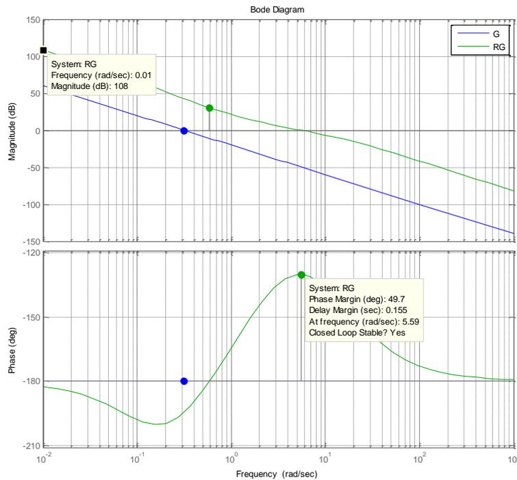
El margen de fase y la frecuencia de corte los medimos directamente en el diagrama de bode:
