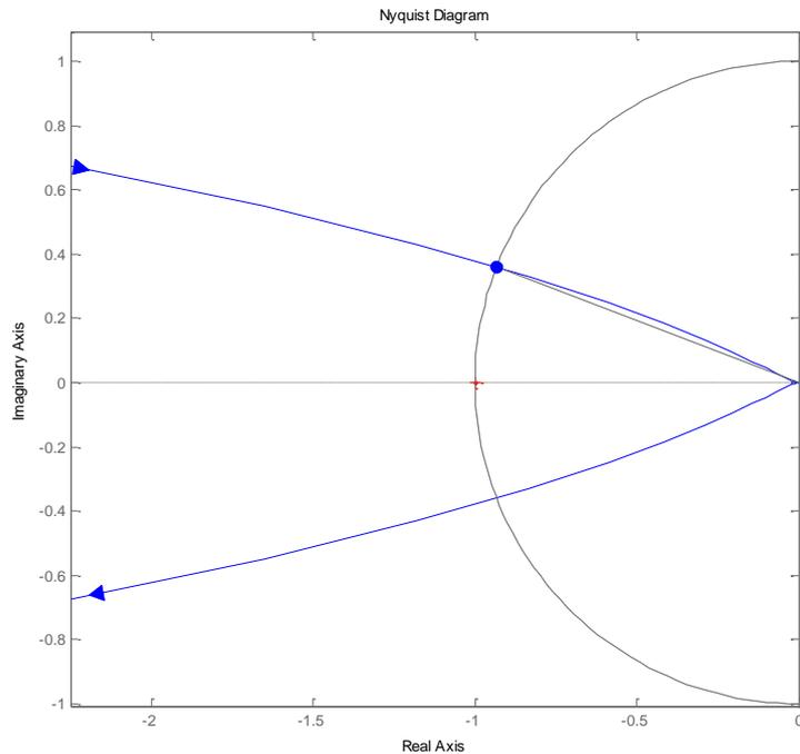
c) Para estabilizar el sistema, necesitamos un regulador que aporte fase, modificando la curva de fases, esto es, un PAF:
