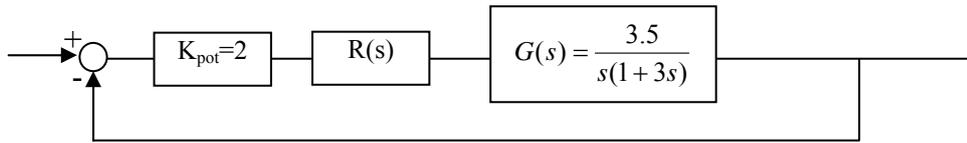
Para conseguir un error de velocidad de cero será necesario que el sistema sea de tipo II, como es de tipo I, necesitaremos un regulador con una parte integral. Probamos con un PI, compensando el polo del sistema:
