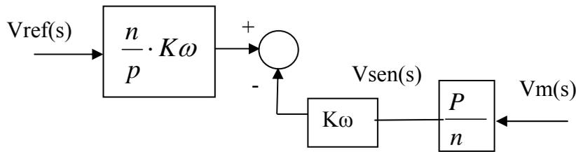
c) El sistema realimentado, teniendo en cuenta que se necesita un acomodación igual a la constante del potenciómetro utilizado en la realimentación de la posición de la masa y habiendo simplificado el sistema será el siguiente:
