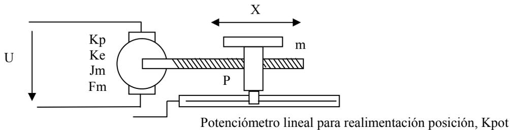
El sistema de la figura consiste en una plataforma de masa  $m$  que es desplazada horizontalmente mediante un husillo sinfín de constante  $P$ , movido por un motor de continua controlado por inducido con constante eléctrica  $K_e$ , constante de par  $K_p$ , una resistencia de inducido  $R$ , inercia en el rotor  $J_m$  y rozamiento viscoso  $F_m$ . La plataforma se puede desplazar a cualquier posición  $X$  dentro del rango permitido por el husillo.
