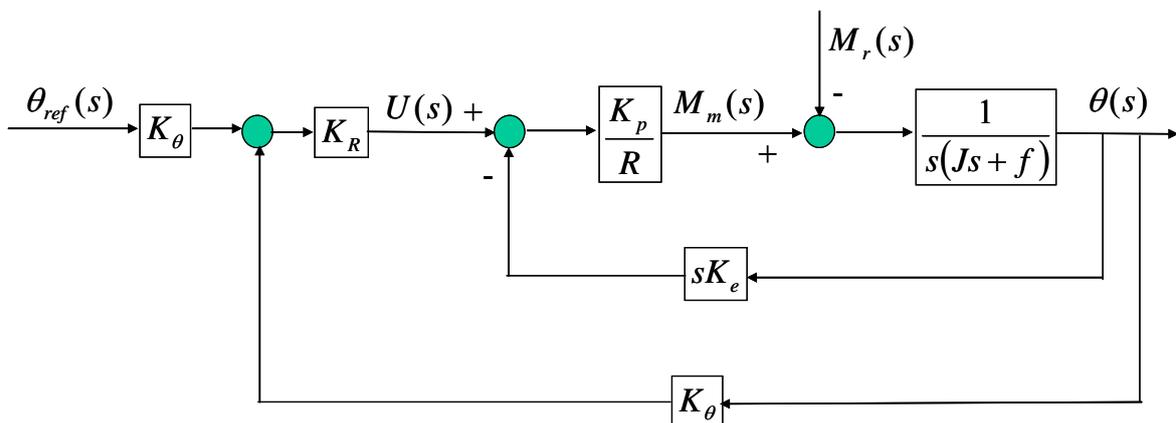
Este par deberá ser opuesto pero del mismo valor al par motor  $M_m$  producido al alimentar el inducido del motor con la tensión de régimen permanente observada en la primera gráfica y debida al error. Es por esto que, al ser  $M_m(t) - M_r(t) = 0$ , el ángulo en régimen permanente permanece invariable, manteniéndose el error de posición a pesar de ser detectado por el sistema.
