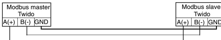
El cableado de este ejemplo muestra una conexión punto a punto sencilla. Las tres señales A(+), B(-) y GND están cableadas de acuerdo con el diagrama.
