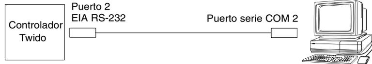
La configuración de hardware está formada por dos conexiones serie del PC al controlador Twido con un puerto 2 opcional EIA RS-232. En un controlador modular, el puerto 2 opcional es un TWDNOZ232D. En el controlador compacto, el puerto 2 opcional es un TWDNAC232D.
