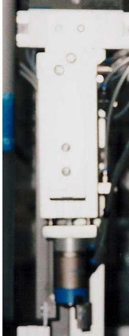
Figura 38: Accionador C, pinza sube_baja.
