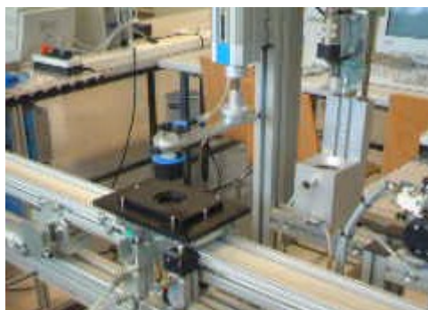
Figura 98: Captura del cilindro por el brazo con las ventosas.
