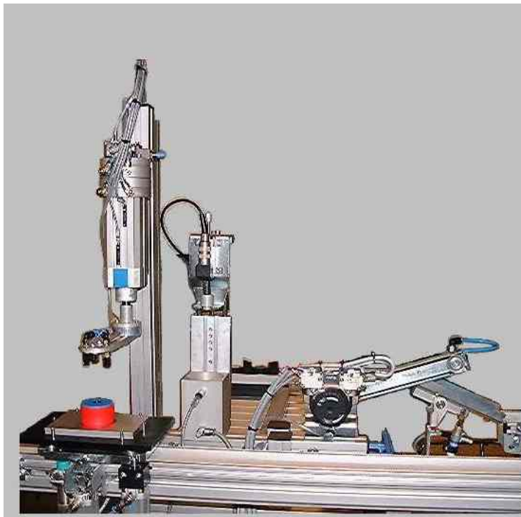
Figura 97: Imagen de la estación de verificación.
