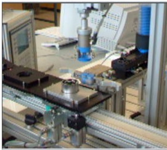
Figura 64: Colocación de la culata en un cilindro.
