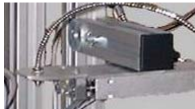
Figura 35: Lector óptico para leer la tapa.
