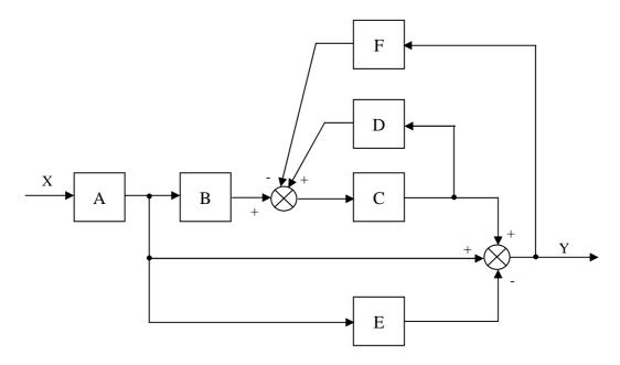
1.3. La figura representa el diagrama de bloques de un conjunto motor-accionador de corriente continua controlado por inducido, con realimentación de velocidad y de intensidad.
